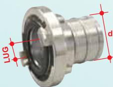
I raccordi STORZ, usati in Germania ed in quasi tutto il nord Europa, sono in lega leggera, simmetriche entrambe le estremità, ad innesto rapido con una piccola rotazione. Per ordinare occorre specificare il diametro della manichetta "d" e il "LUG space" che è la distanza interna in millimetri fra i due denti.
