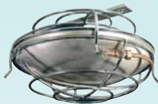
Il calore repentino del fuoco scalda l'aria che si espande aumentando la pressione trasmessa con un sottile tubo in rame capillare al comando pneumatico, 41030. Non necessita di nessuna energia. Sensibile a sbalzi rapidi di temperatura.
