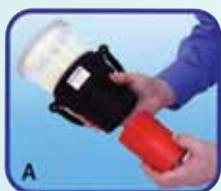
Questa asta telescopica permette di eseguire la manutenzione dei rivelatori di fumo. Permette di spruzzare tramite la bomoletta spray un getto che attiva il rivelatore e lo pulisce dalla polvere.
