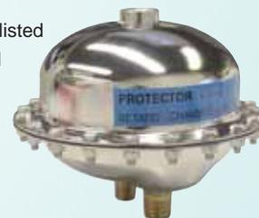
Montato sul corpo valvola, ha lo scopo di evitare falsi allarmi della campana idraulica. Infatti in caso di fluttuazioni della pressione nella rete idrica può avvenire la temporanea apertura del piattello valvola anche in assenza di un reale flusso normalmente dovuto ad apertura di uno sprinkler.
