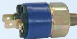
Il pressostato, montato sull'estintore automatico, permette la chiusura automatica della valvola del gas del locale caldaia e di azionare un allarme ottico acustico.
