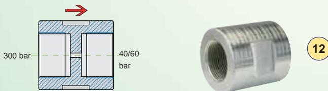
Necessario per ridurre la pressione del gas durante la scarica dal collettore alle linee di distribuzione, da 300 bar della bombola ai 40 ÷ 60 bar dopo l'orifizio. La foratura è determinata dal calcolo computerizzato.
