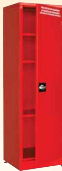
Armadio antincendio di sicurezza, verniciatura a forno in epossipoliestere colore rosso RAL3000, realizzato in lamiera 10/10 con spigolo arrotondato, chiusura ad asta con serrature in plastica e alluminio, cavo di messa a terra, 1 anta cieca, 3 ripiani.
