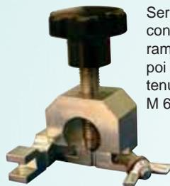
Serve a creare la svasatura conica interna al tubetto di rame capillare 3x2 per avere poi la perfetta giunzione e tenuta con i raccordi 3x2 filetto M 6x0,75.
