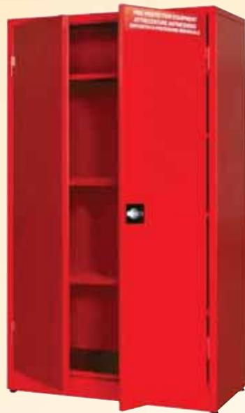
Armadio antincendio di sicurezza, verniciatura a forno in epossipoliestere colore rosso RAL3000, realizzato in lamiera 10/10 con spigolo arrotondato, chiusura ad asta con serratura in plastica e alluminio, cavo di messa a terra, 2 ante cieche, 3 ripiani.
