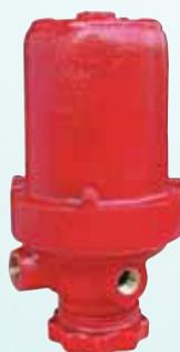
L'acceleratore di aria è usato negli impianti a secco. Il suo scopo è quello di accelerare la fuoriuscita di aria dalle tubazioni permettendo all'acqua di arrivare tempestivamente allo sprinkler intervenuto per incendio. Viene montato sul corpo della valvola a secco
